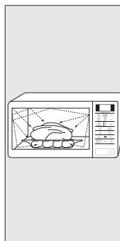
1. Волны СВЧ, генерируемые магнетроном, равномерно распределяются в процессе вращения блюда на врачающемся подносе. За счет этого пища готовится равномерно.
