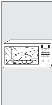
1. Магнетронды тұтіктен шыққан микротолқын, бұрылмалы табақтың үстінде айналып тұрған тағамға біркелкі таралады. Сондықтан да, тағам біркелкі піседі.
